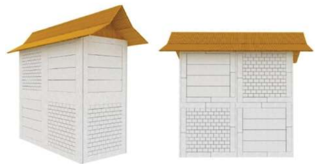
Gambar 6 Material Atap Bambu pada Struktur dan Dinding Panel
